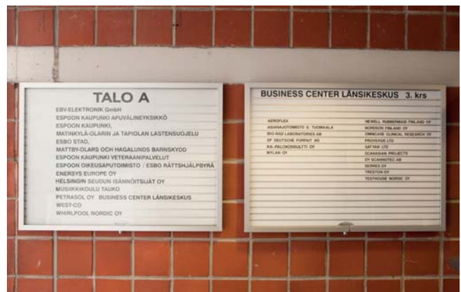
Porrastaulu lukittavalla suojakannella. Vaihdeettavat OK25-liuskat tarratekstein.
